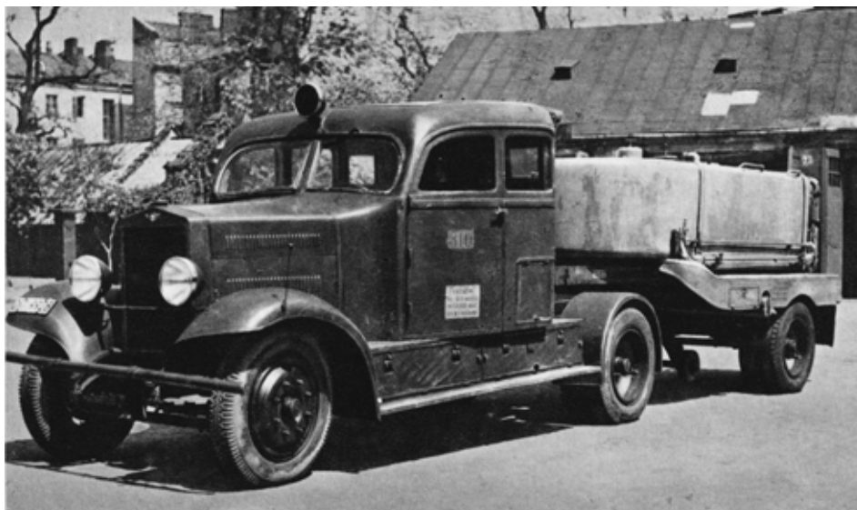
Samochód WSO marki Fiat z cysterną 4500 l, 1939 r. Źródło: ze zbiorów Sebastiana Stranianka
